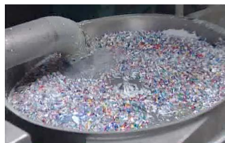
Séparation des plastiques par flottage, source VALORPLAST
